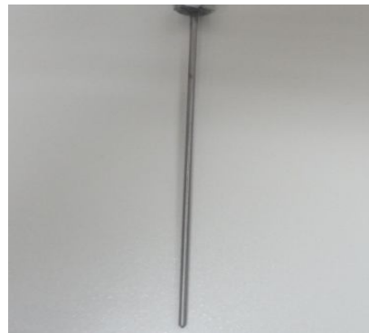
شکل ۱- تصویر پروب مورد استفاده در تعیین سفتی بافت کشمش
