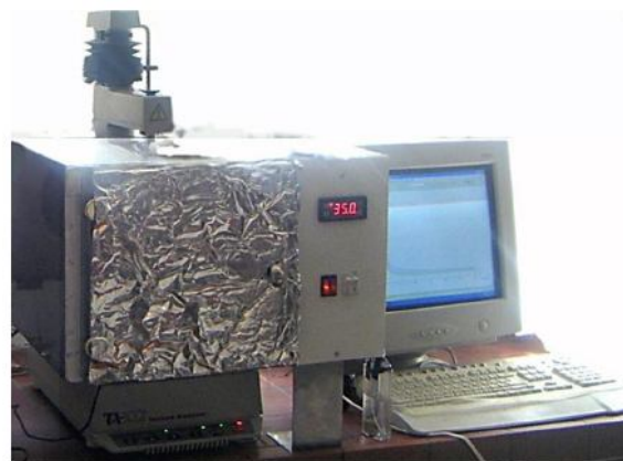
شکل ۲- محفظه کنترل دما اطراف پراب دستگاه TPA
