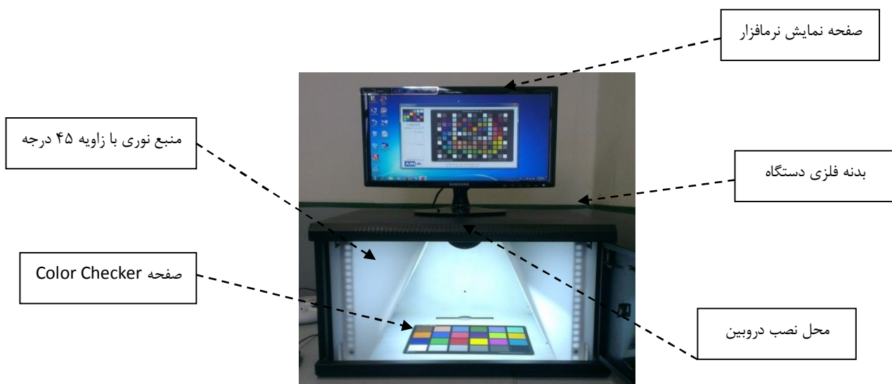
شکل ۱- نمایی از دستگاه سنجش رنگ IMG-Pardazesh Cam-System XI
