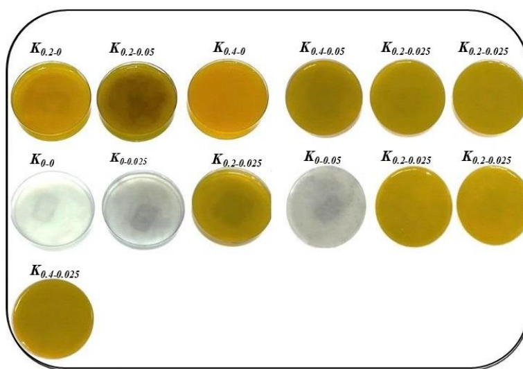
شکل ۱- فیلم‌های تهیه شده از کامپوزیت پودر ثعلب/پودر زردچوبه و سلنیوم
