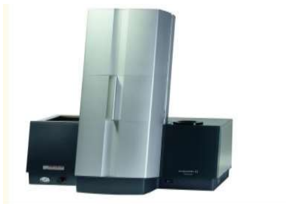
شکل ۲- دستگاه اندازه‌گیری ذرات به روش پراش لیزری و چگونگی برخورد پرتوها به دانه خاکشیر
