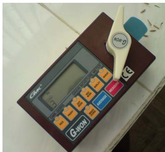
شکل ۲- دستگاه رطوبت‌سنج دیجیتالی برای اندازه‌گیری درصد رطوبت نمونه‌ها
