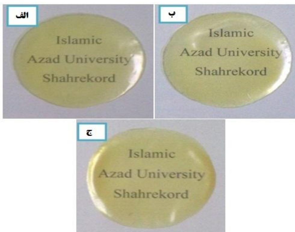
شکل ۱- تصاویر فیلم های تهیه شده از فیلم های ایزوله پروتئین سویا: کتیرا به ترتیب با نسبت های الف) ۴/۵: ۰/۵، ب) ۴/۷: ۰/۳ و ج) ۴/۹: ۰/۱
