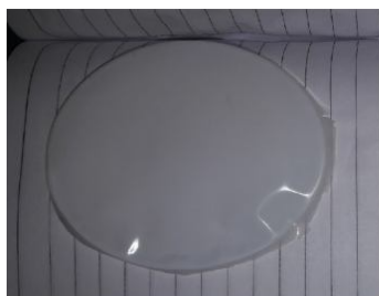
(ب) فیلم حاوی 3 درصد وزنی نانو اکسید روی
