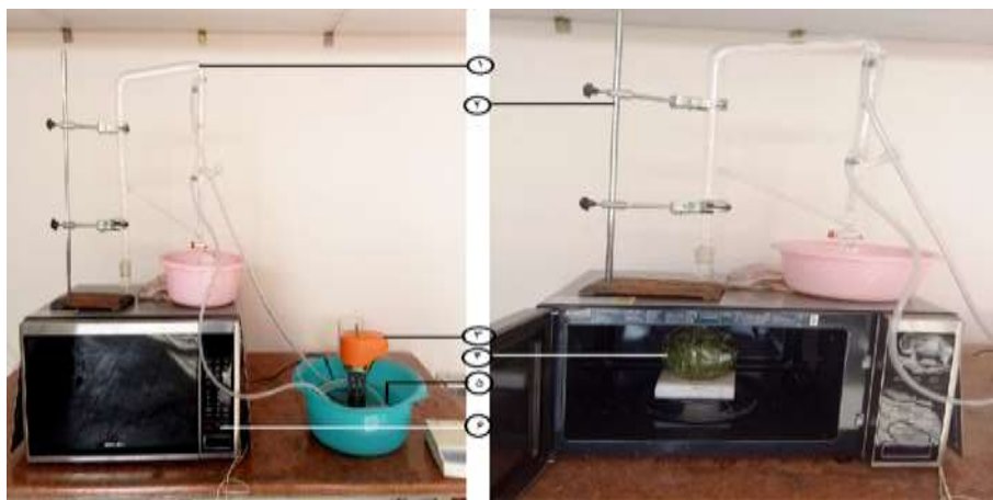
شکل ۱- سامانه اسانس گیری: ۱- کندانسور، ۲- پایه و گیره، ۳- پمپ آب، ۴- بالن، ۵- آب و یخ، ۶- میکروویو
