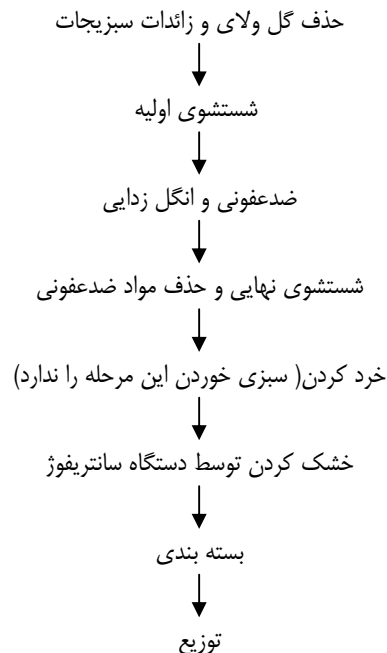
شکل ۱- نمایش شماتیک مراحل کار در یک کارگاه بسته بندی سبزیجات.
