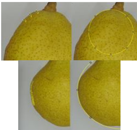
شکل 3- تعیین شعاع انحناء: (شکل بالا) با در نظر گرفتن سه نقطه، (شکل پایین) با در نظر گرفتن بیش از سه نقطه
