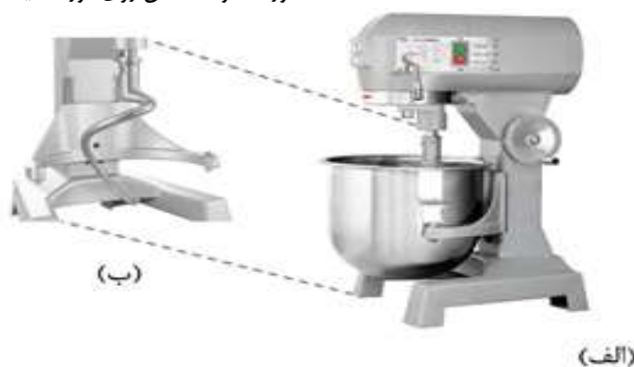
شکل ۱- تجهیزات تهیه خمیر دونات (الف) همزن نیمه صنعتی (ب) پروب همزن
