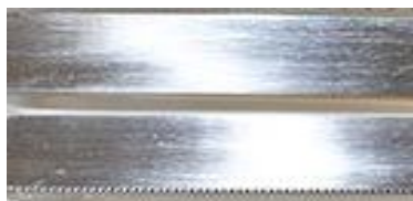
شکل ۱- تیغه‌ای مورد استفاده الف- لبه صاف ب- لبه اره‌ای
