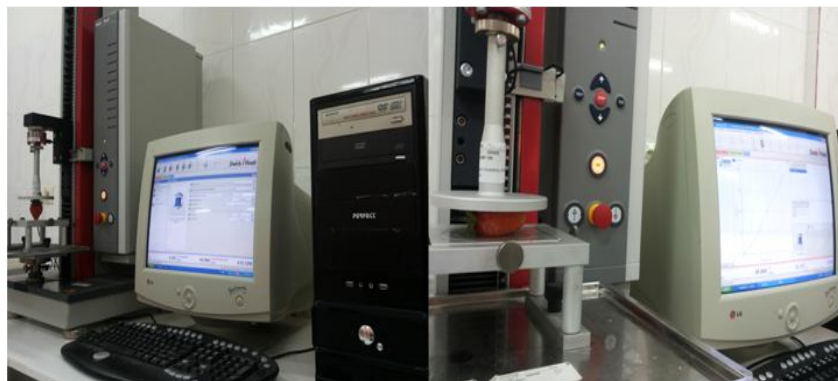
شکل 3- دستگاه اندازه گیری سفتی و نقطه تسلیم بیولوژیکی
