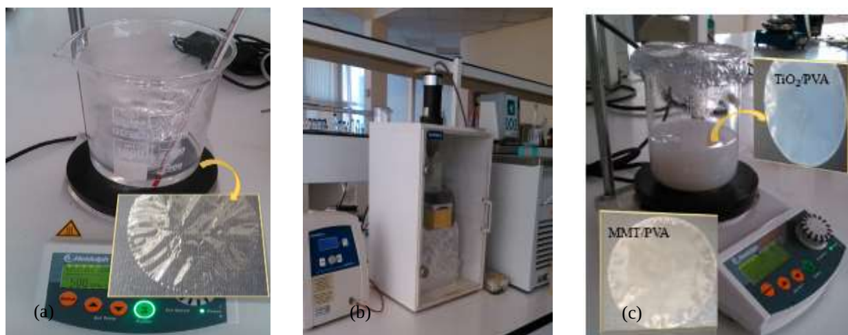
شکل ۱- آماده سازی فیلم‌های نانوکامپوزیتی، (a) پلیمر خالص PVA، (b) هموژنایزر اولتراسونیک، (c) نانوکامپوزیت MMT/PVA و TiO 2 /PVA.
