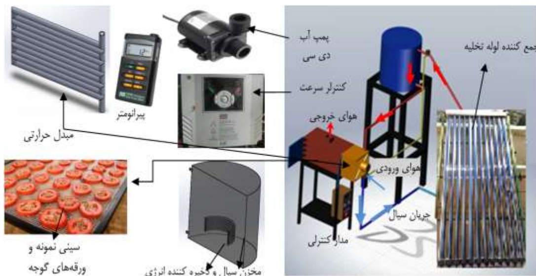
شکل ۲- شماتیک خشک کن کابینتی مجهز به جمع کننده لوله تخلیه (خلا)
