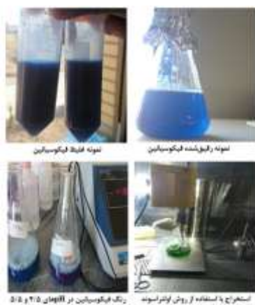
شکل ۲- استخراج نمونه‌های فیکوسیانین از میکرو جلبک اسپیرولینا پلاتنسیس
