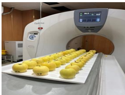
شکل ۱- تصویربرداری سیب با دستگاه سی‌تی اسکن Fig. 1. Apple imaging with a CT scan machine
